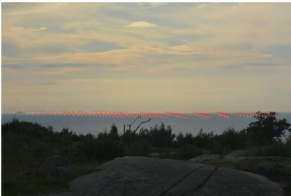
Figur 45. Visuell analys baserat på samma foto som Figur 44. I denna analys är turbinerna representeras av röda cirklar samt ritas in framför havet fast de egentligen ligger skynda bakom havets krökning. Av denna analys ser man att de närmaste turbinerna i vänstra delen av bilden sticker upp ca 200 m ur havet (den del som ligger över horisonten), men pga. att sikten reduceras är det väldigt svårt att se turbinerna i Figur 44.
