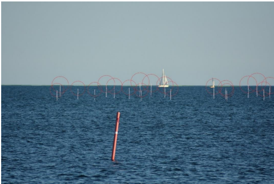
Figur 47. Visuell analys baserat på samma foto som nedre bilden i Figur 46. I denna analys är turbinerna representerade av röda cirklar samt ritats in framför havet fast de egentligen ligger skymda bakom havets krökning. Av denna analys ser man att de närmaste turbinerna i högre delen av bilden sticker upp ca 200 m ur havet (den del som ligger över horisonten), men pga. att sikten reduceras är det väldigt svårt att se turbinerna i Figur 46.
